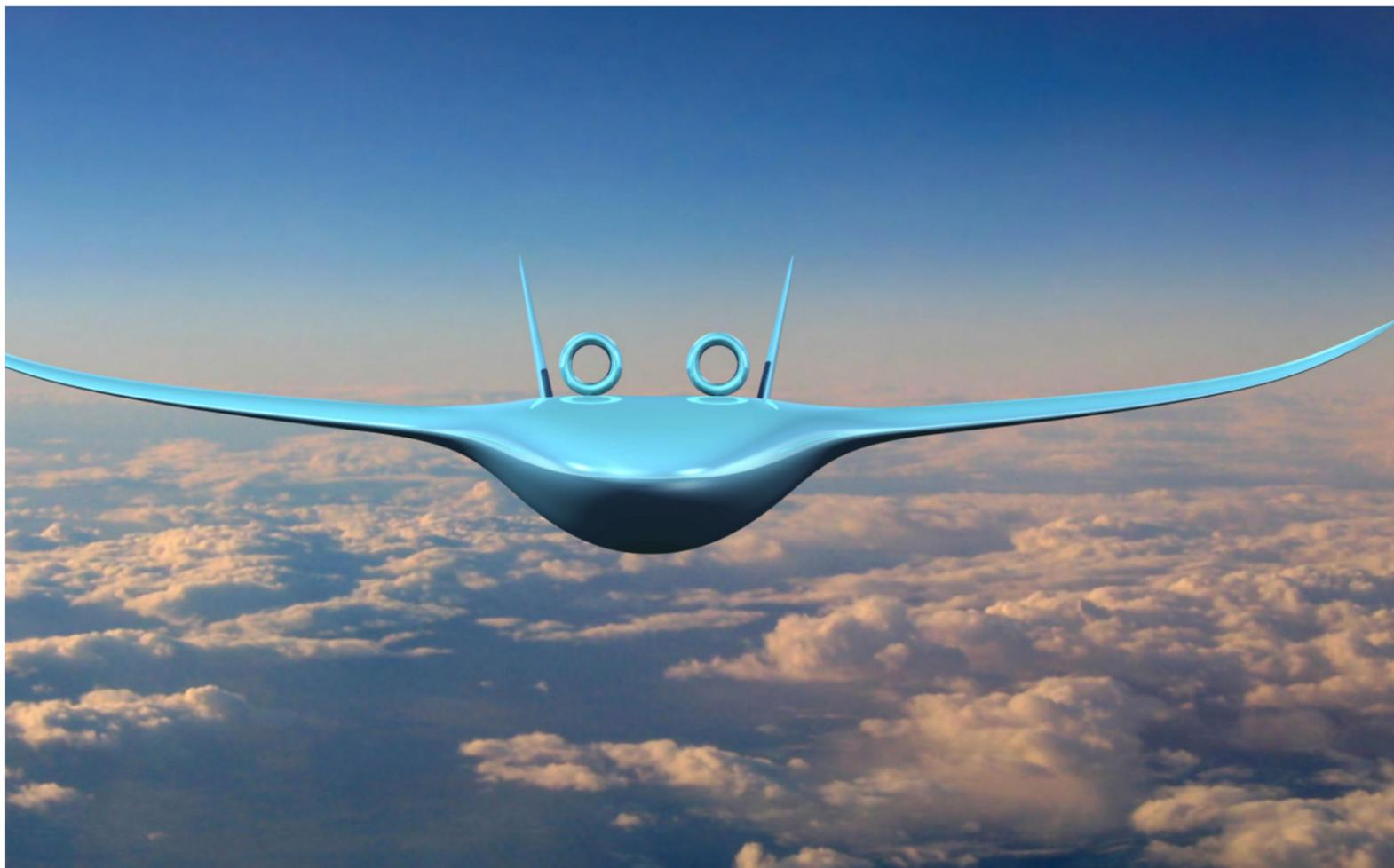
中去，最关键的是安全性必须达标，其次是经济性，同时还要建立该种机型飞机的适航条例。目前“SA-80 龙雀号”的飞机机型研制工作还处于起步阶段，虽然这款翼身融合布局有一定的优势，但是也存在诸多缺点，比如目前机型的气动与结构耦合能力较强，两侧受力感觉明显，飞机的稳定性和操控性有些偏弱，尚未开展起降增升系统的设计。另外，由于目前机型太小，尚未开展高速性能的测试。这些都需要后续开展持续的研究工作去探索和攻克。
