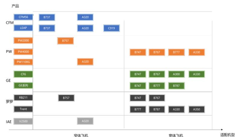
图7 | 主要民用发动机型号与民用飞机的适配关系
