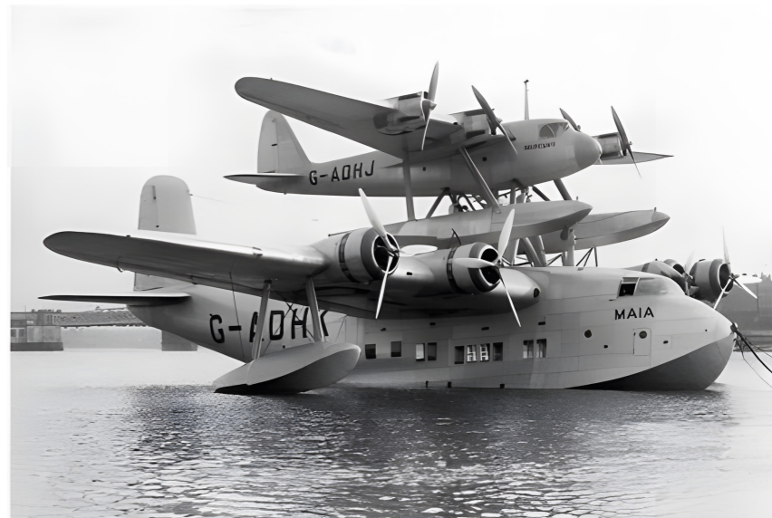
▲ “子母飞机”，下面的运载机是肖特S21“迈亚”船身式上单翼飞机；上面是S20“水银”子飞机
